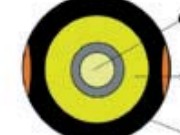
Zentralrohraufbau / Central tube construction
