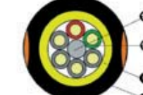
Verseilter Aufbau / Stranded construction
